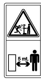
Il est interdit de stationner dans le rayon d'action de la machine. A part l'opérateur aucune personne ou animal ne peut stationner dans un périmètre de 5 m de la machine.
