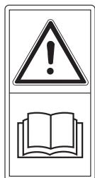
Vor der Inbetriebsetzung der Maschine sind die Betriebs- und Wartungsanleitungen genau durchzulesen.
