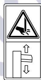
Danger de coupure ou d'écrasement de la main: ne jamais toucher les zones à risque lorsque la lame est en mouvement.
