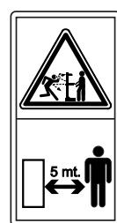
È vietato sostare nel raggio di azione della macchina quando questa è in moto. Nessuna persona o animale può sostare in un raggio di cinque metri dalla macchina durante il normale funzionamento della stessa.
