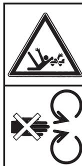
**7 PERICOLO DI TRASCINAMENTO** con cardano in rotazione.
